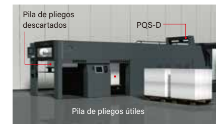
Pila de pliegos descartados; PQS-D; Pila de pliegos útiles
