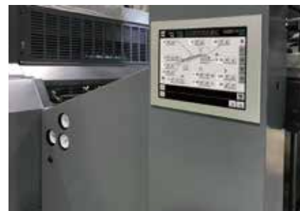
Monitor de pantalla táctil de 10" de la sección del alimentador
