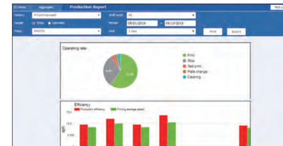
Reporte de producción Muestra datos de producción como desperdicio de hojas, tasa de operación, eficiencia y extractos diarios.
