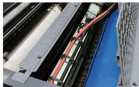
Inter-deck de unidad LED-UV sobre el cilindro de impresión
